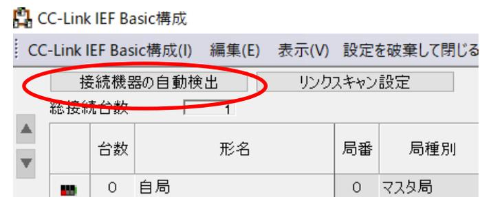
PLCとBNI00E7を接続した状態でCC-Link IEF Basic構成画面で接続機器の自動検出をクリック(PLC内蔵EthernetポートのIPアドレスはBNI00E7とは第4オクテットを違うアドレスに設定)
